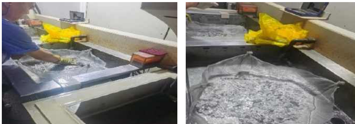
Hình 1. 15. Hình ảnh minh họa công đoạn rửa nước sau tẩy gỉ
