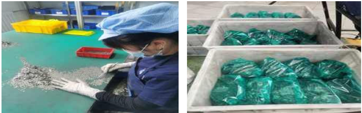
Hình 1. 11. Hình ảnh minh họa bước kiểm tra ngoại quan, đóng gói chuyển sang quy trình mạ điện
