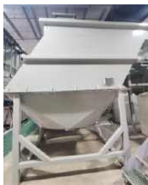
Bể lắng keo tụ
