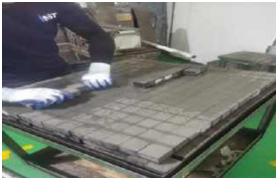
Hình 1. 5. Hình ảnh minh họa bước làm sạch bề mặt phôi nam châm
